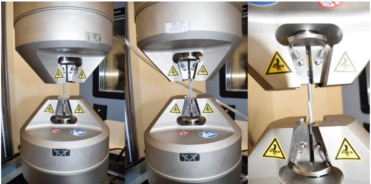
Obrázek 25 Pohyb čelisti při statické zkoušce na krut
