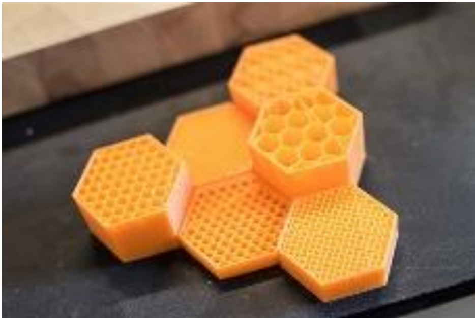
Obrázek 1 Vnitřní struktura tištěných částí [2]
