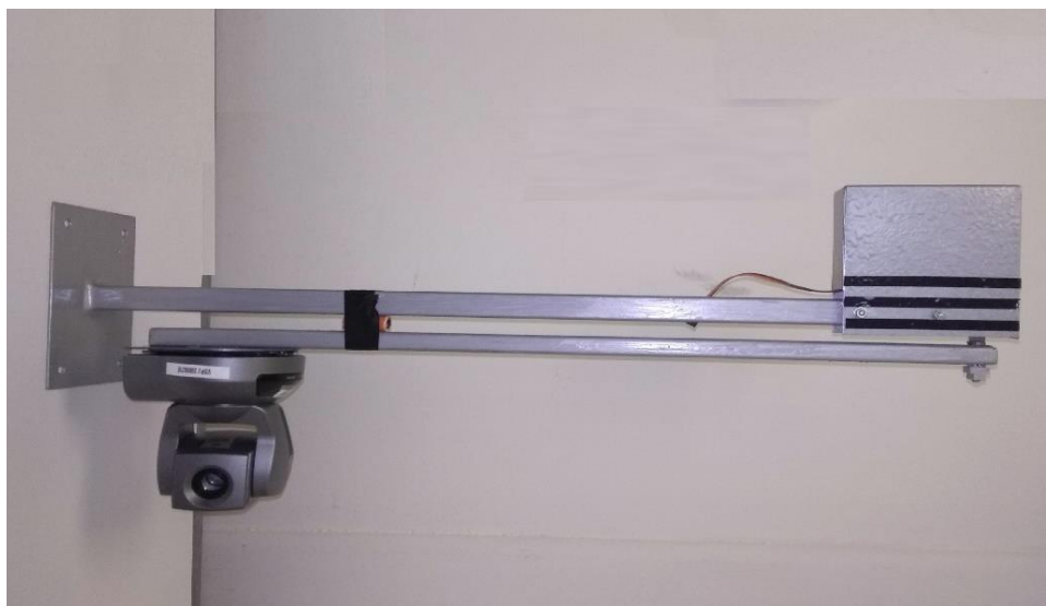
Obrázek 5 Rameno pro otáčení kamery (Vlastní zpracování)
