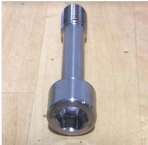
Příloha A.4 Specifický šroub z niklové slitiny (vlastní fotografie)
