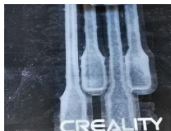
Obr. 19 Nerovnoměrné chladnutí materiálu
