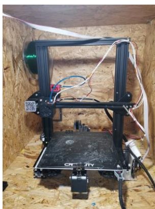
Obr. 12 Upravená 3D tiskárna Ender3pro v tepelné komoře
