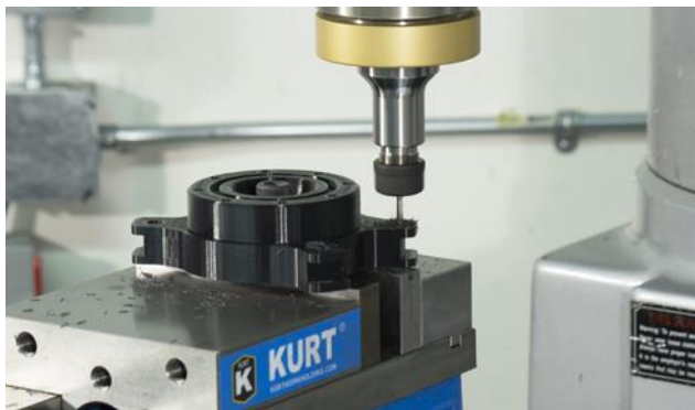
Obr. 1 Obrábění tištěného dílu z PA (Stratasys, 2021)
