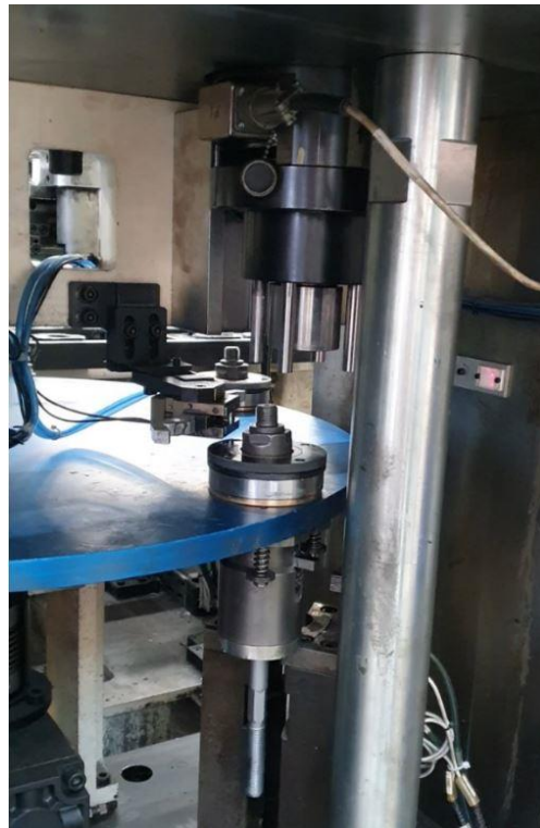
Obrázek 21 a 22 – Vyjmutí čepu s koulí ze zásobníku (vlevo) a lisování (vpravo) [zdroj: vlastní]
