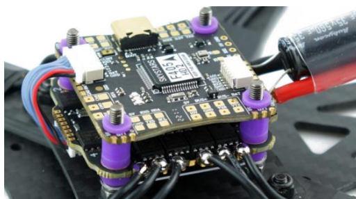
Obr. 22: Připojení řídicí jednotky
