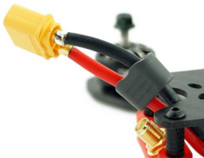
Obr. 26: Napájení konektoru XT60 pro baterii
