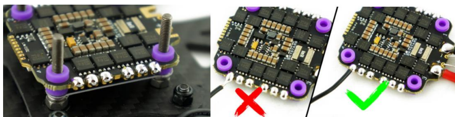
Obr. 19: Napájení motorů na regulátor
