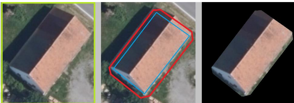
Obr. 6: Ukázka segmentace střechy – zleva lokalizace budovy pomocí BBOX, uprostřed obraz budovy s polygonem RÚIAN (modrá) a buffer 2,5 m (červená), vpravo segmentovaná střecha budovy Zdroj: vlastní zpracování
