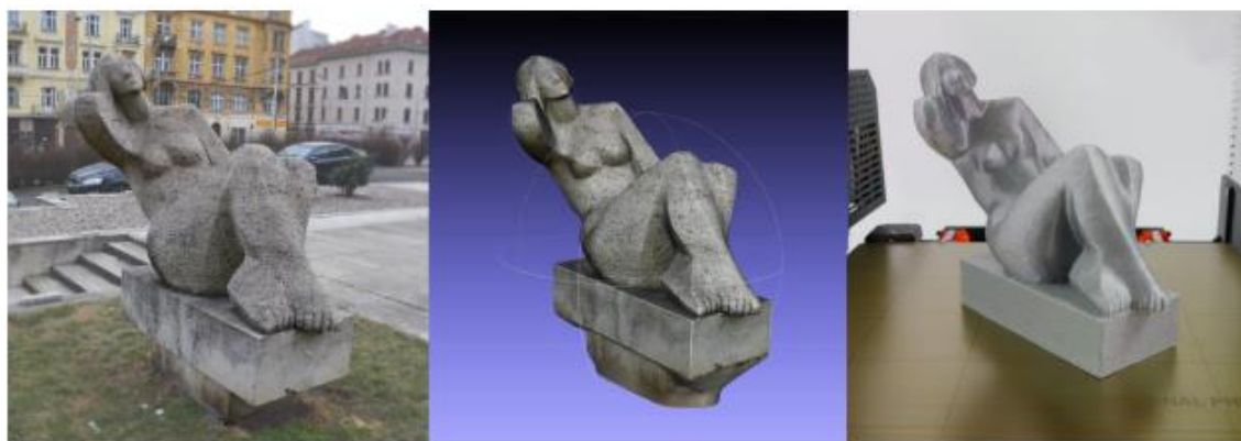
Obr. 14: Porovnání: Objekt/3D model/vytištěný model
