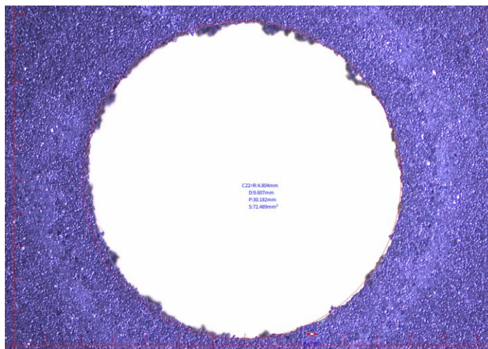
Obr. 24: Snímek z měřicího mikroskopu pořízený při měření otvoru
