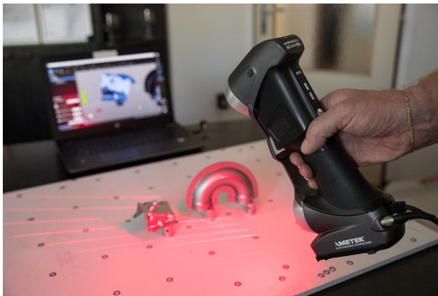
Obr. 13: 3D skenování ručním skenerem
