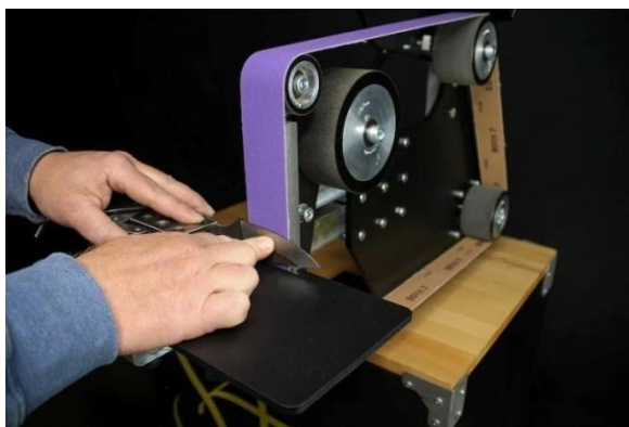
Obr. 2: Uspořádání pásové brusky pro výrobu klínového výbrusu čepele
