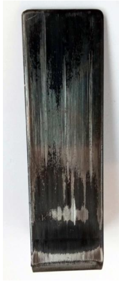
Obr. 17: Opatřebení opěrné desky hobby pásové brusky
