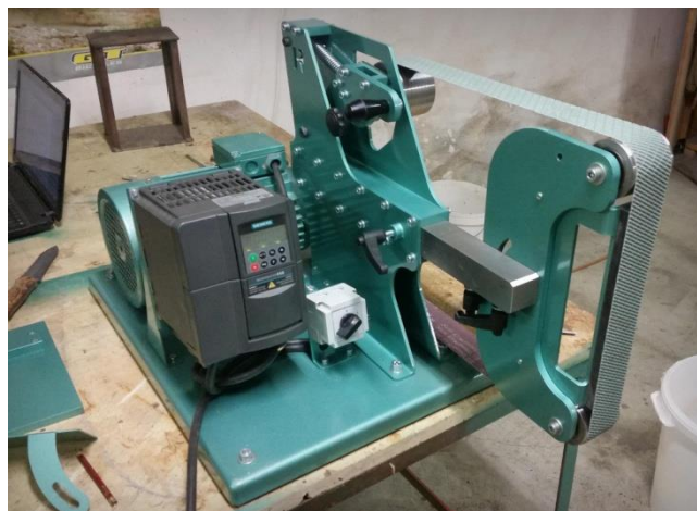
Obr. 6: Pásová bruska vyrobená vlastními prostředky
