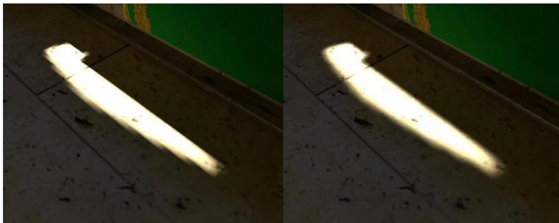
Obr. 7: Porovnání povrchu osvětleného stejnou lightmapou za využití bilinéárního filtrování (vlevo) a bikubického filtrování (vpravo)
