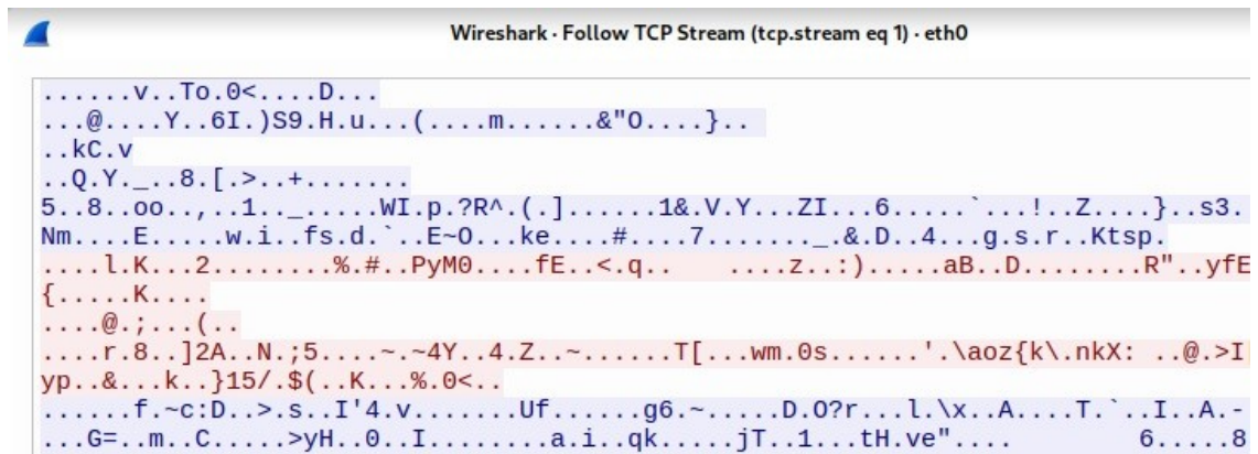
Obr. 26: Wireshark, nečitelná data HTTPS komunikace Zdroj: Vlastní zpracování (2026)
