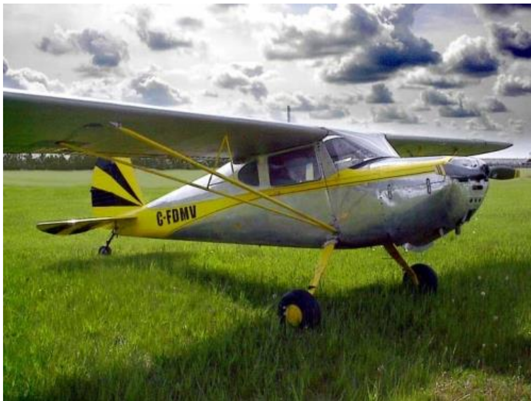
Obr. 21: Letadlo s ostruhovým podvozkem
