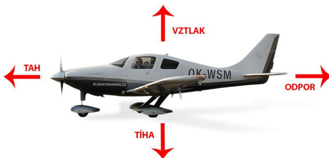
Obr. 10: Síly působící na letadlo
