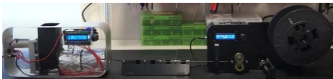
Obr. 20: Původní sestava pro výrobu filamentu
