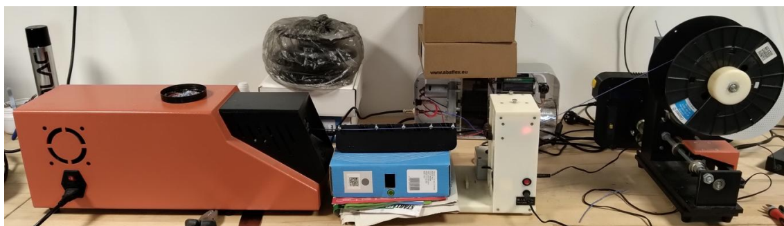
Obr. 21: Výsledná sestava pro výrobu filamentu
