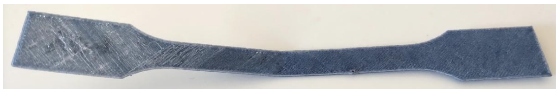
Obr. 44: Nedokončený výtisk modelu pro tahovou zkoušku
