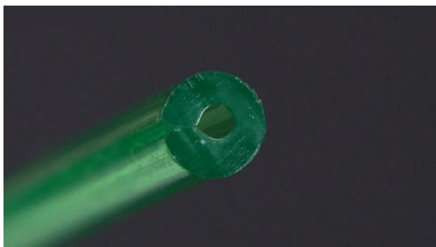
Obr. 66: Tvar profilu filamentu vyrobeného z pásku PET lahve
