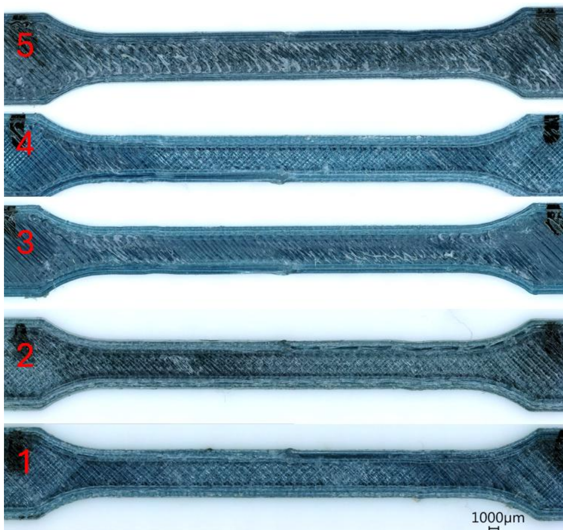
Obr. 58: Struktura vzorků pro tahovou zkoušku (50x zvětšeno)
