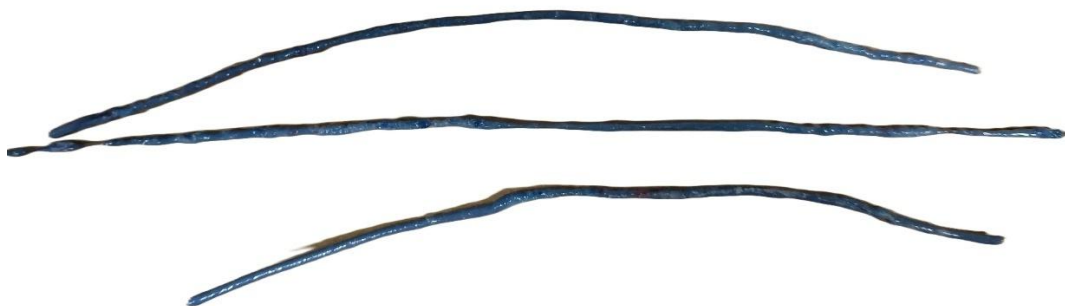
Obr. 33: Filament vzniklý při nižších teplotách
