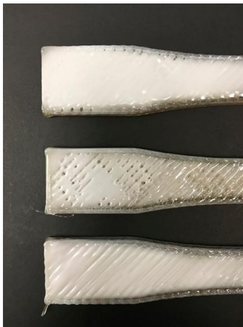
Obr. 68: Struktura vzorků vytištěných přímým 3D tiskem
