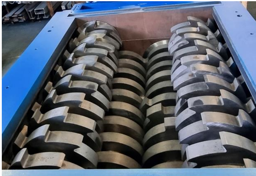
Obr. 5: Pracovní prostor čtyřhřídelového drtiče
