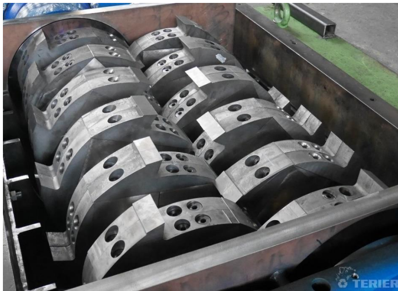
Obr. 4: Pracovní prostor dvouhřídelového drtiče
