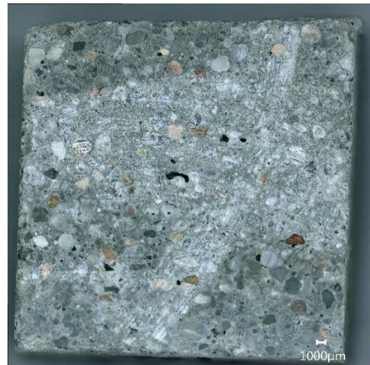
Obrázek 12: Mikrostruktura betonového vzorku z vlastní míchané betonové směsi s ocelovou výztuží \varnothing 2 mm po 28 dnech hydratace (optická mikroskopie, zvětšení 50x)
