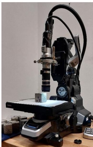
Obrázek 2: Mikroskopické pozorování betonového vzorku v laboratorních podmínkách
