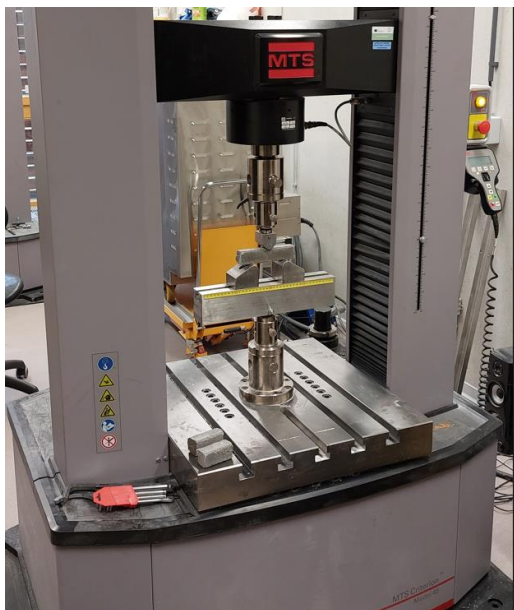
Obrázek 3: Zkušební zařízení pro tříbodovou ohybovou zkoušku
