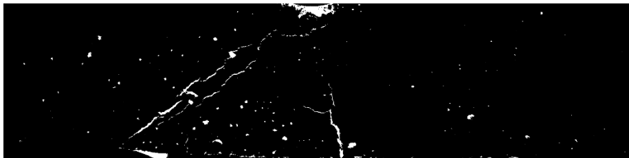
Obrázek 16: Binární obraz trhlín betonového vzorku z vlastní míchané betonové směsi s ocelovou výztuží \varnothing 4 mm po 28 dnech hydratace, získaný zpracováním snímku v softwaru ImageJ
