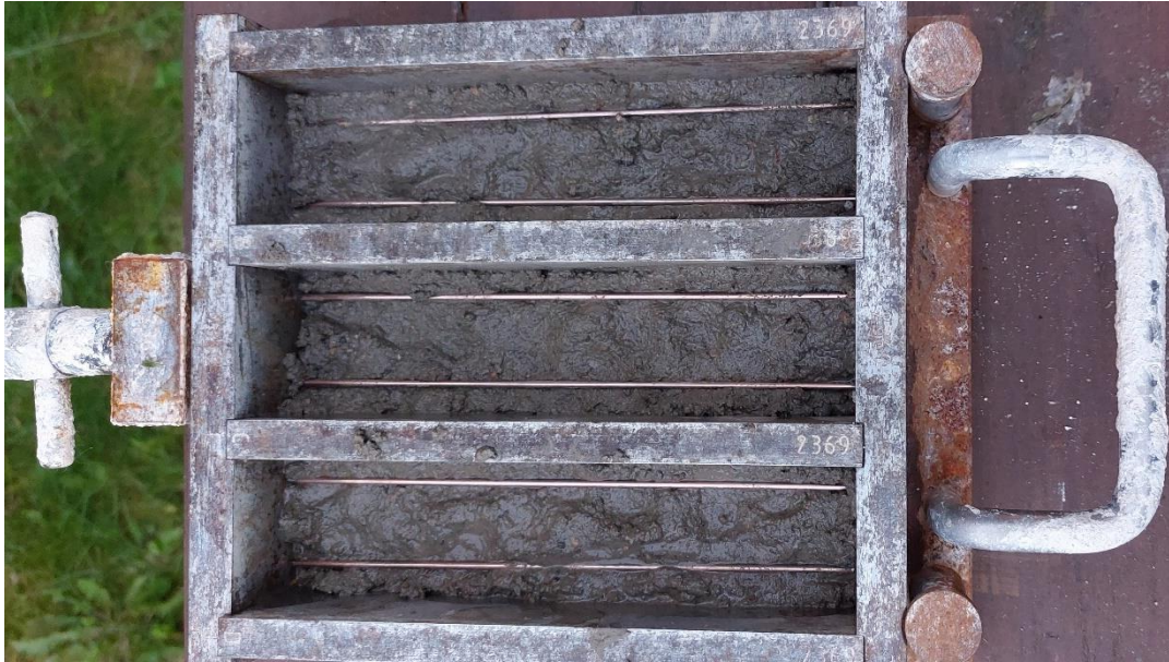
Obrázek 1: Příprava betonových zkušebních těles ve formách
