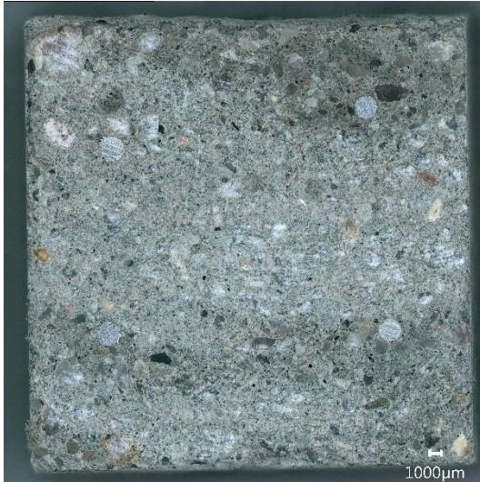
Obrázek 11: Mikrostruktura betonového vzorku z cementového potěru s ocelovou výztuží \varnothing 2 mm po 28 dnech hydratace (optická mikroskopie, zvětšení 50x)
