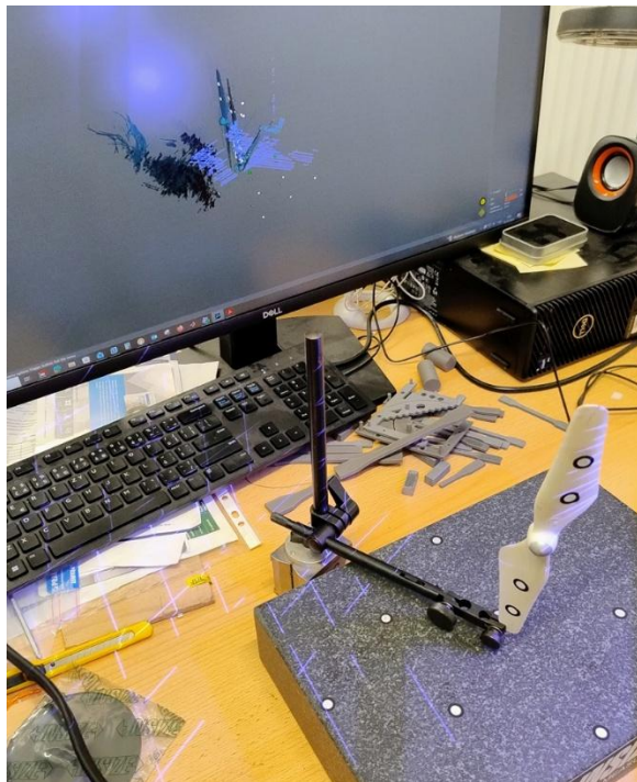
Obrázek 25: LaserPatch režim, na obrazovce je možné vidět real-time záznam naskenovaných bodů.
